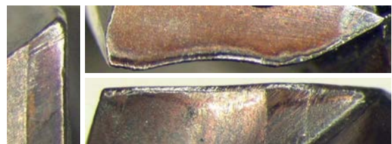
Состояние режущей кромки после 66,4 м сверления
